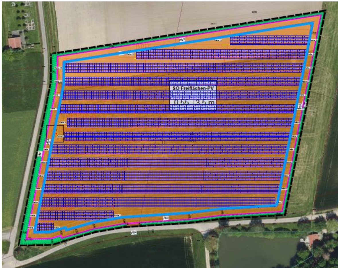
Bild 8: Geplante Belegung der Fläche mit Photovoltaikmodulen
